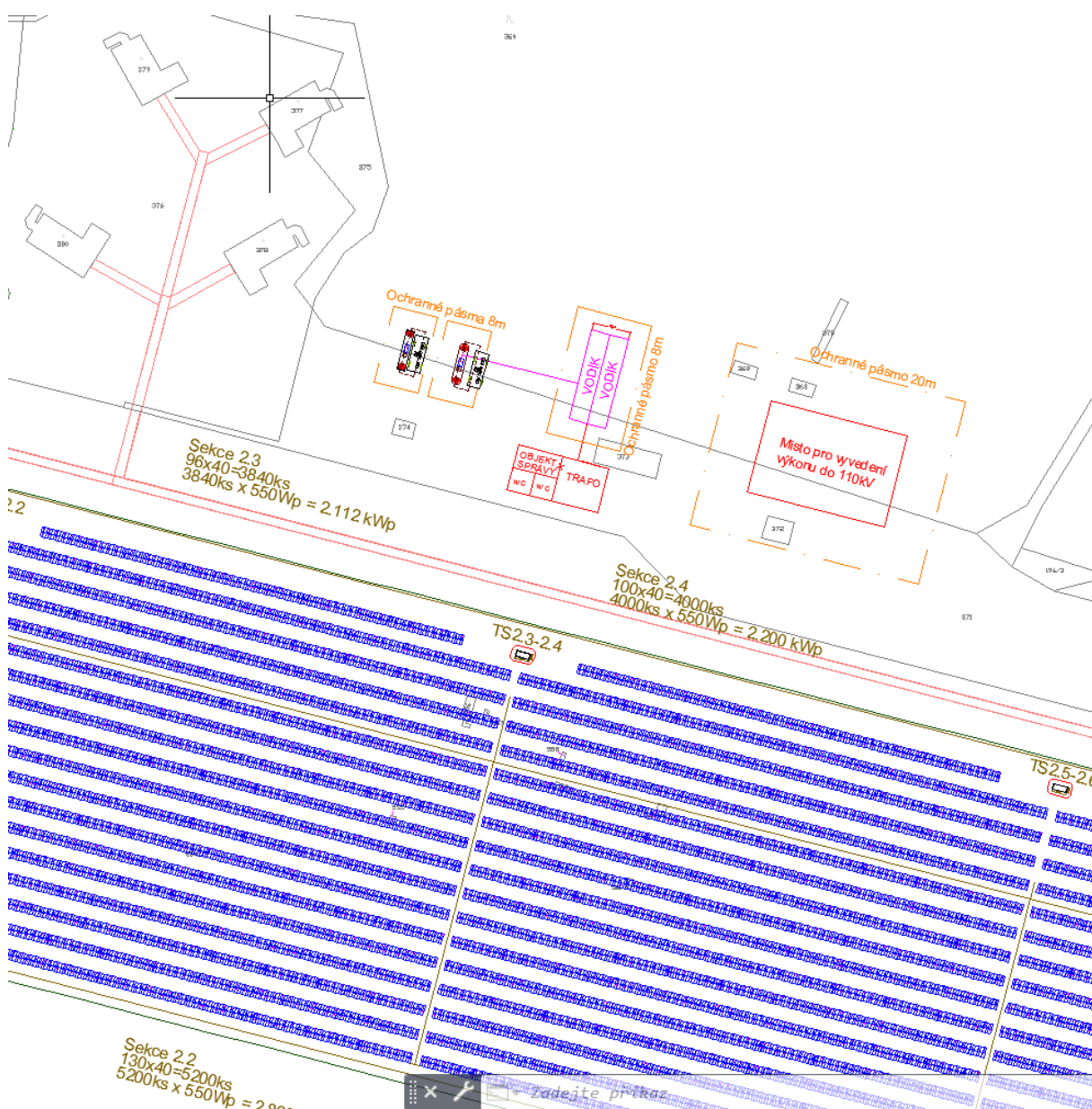
Obr. č. 34 – Vizualizace umístění 110kV rozvodny
